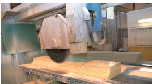
Les Pierres de Frontenac ont débuté une large refonte de leur parc de débêteuses. Plusieurs nouveaux modèles automatiques devraient prochainement remplacer les dernières plus anciennes pour réaliser essentiellement des éléments de placages minces, nouveau marché en pleine croissance.
