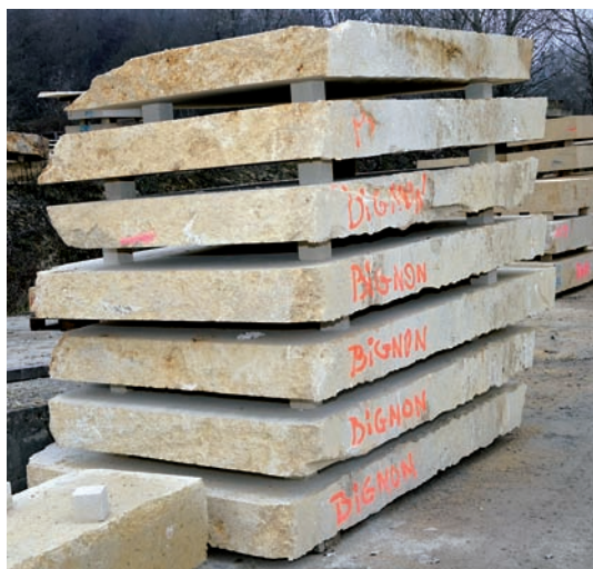
Tranches de pierre de Frontenac, sciées à la dimension du module "Girondin", soit 32,5 cm d'épaisseur. Ci-dessous entrée des bureaux.
