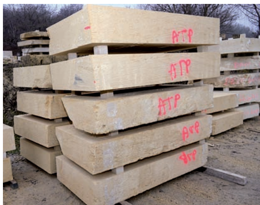
Tranches de pierre de Frontenac, sciées à la dimension du module "Girondin", soit 32,5 cm d'épaisseur. Ci-dessous entrée des bureaux.
