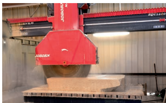
Les Pierres de Frontenac ont débuté une large refonte de leur parc de débêteuses. Plusieurs nouveaux modèles automatiques devraient prochainement remplacer les dernières plus anciennes pour réaliser essentiellement des éléments de placages minces, nouveau marché en pleine croissance.
