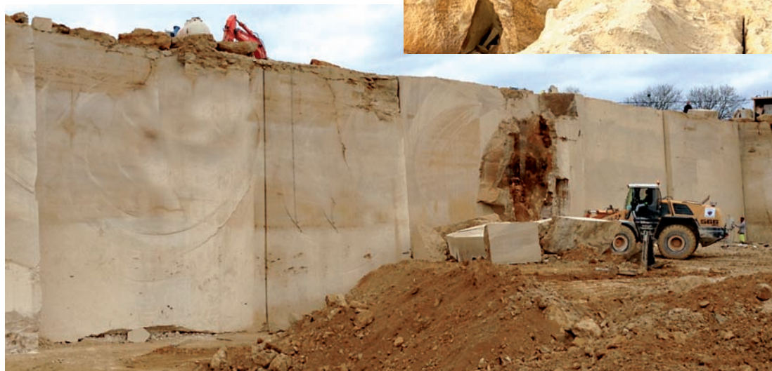
La nouvelle carrière Le Bignon présente un front de taille de 10 m de haut divisé en deux banquettes de 5 mètres. Sciage vertical à l'arrière à la haveuse puis la masse est poussée au godet écarteur.
