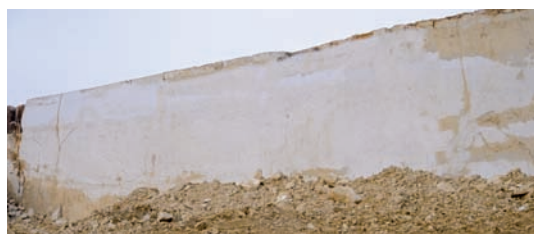
La nouvelle carrière Le Bignon présente un front de taille de 10 m de haut divisé en deux banquettes de 5 mètres. Sciage vertical à l'arrière à la haveuse puis la masse est poussée au godet écarteur.
