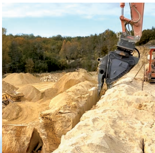
Le disque Echidna de 3,60 m de Ø permet de redimensionner des blocs de 1,5 m de haut maximum. Ce matériel est utilisé aussi pour les coupes horizontales ou dans le cadre de travaux de découverte.
