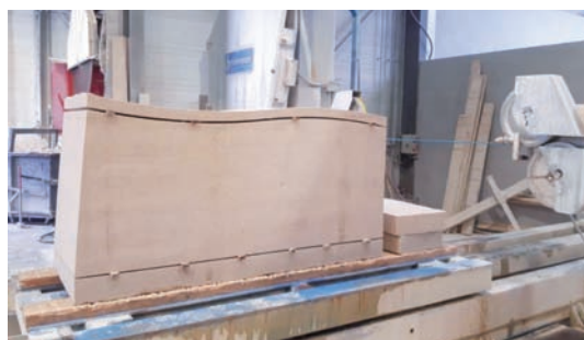
Stocks d'éléments destinés au chantier de Saint-Dizier, chez Rocamat et SNBR. Cette dernière a réalisé les sciages de tous les claveaux. Ceux destinés aux grands arcs ont une légère forme en "S" notamment afin d'agrandir leur surface de contact. Plus de 1 000 morceaux ont été nécessaires à la construction de l'enceinte.
