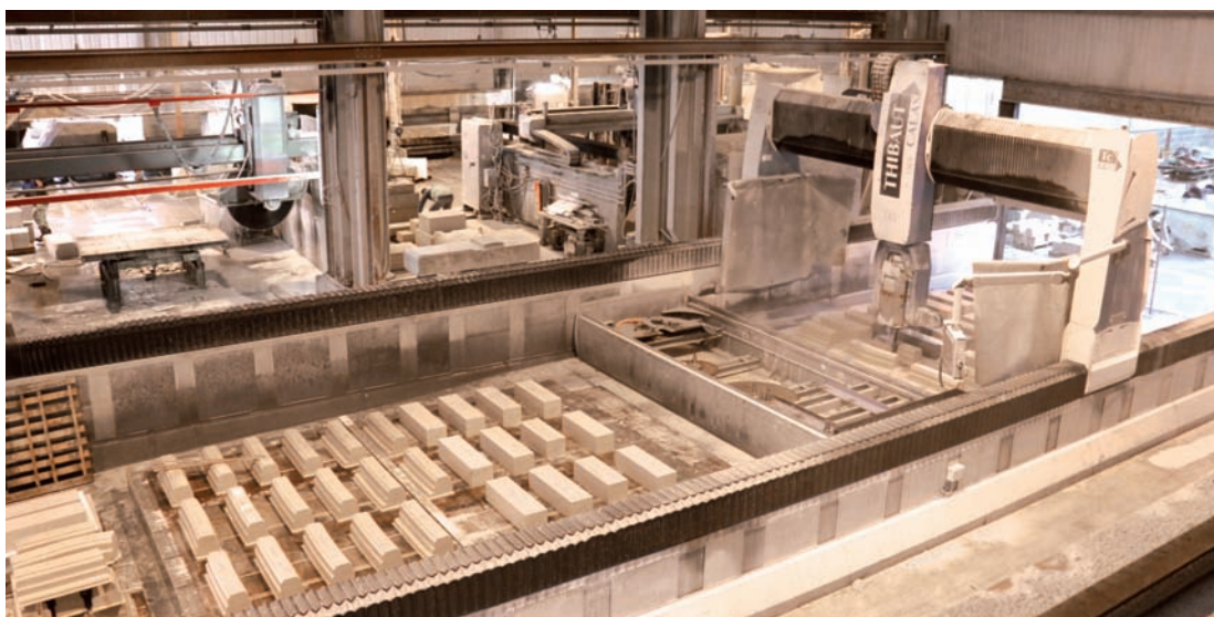
Les Pierres de Frontenac ont débuté une large refonte de leur parc de débêteuses. Plusieurs nouveaux modèles automatiques devraient prochainement remplacer les dernières plus anciennes pour réaliser essentiellement des éléments de placages minces, nouveau marché en pleine croissance.
