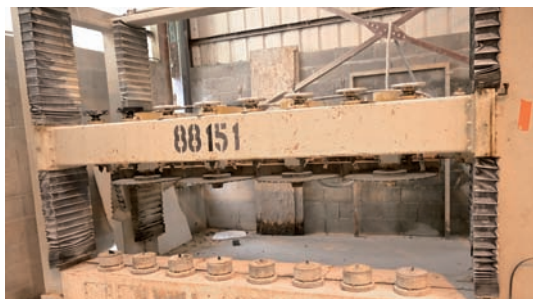
Tour permettant de réaliser jusqu'à 8 balustres à la fois.
